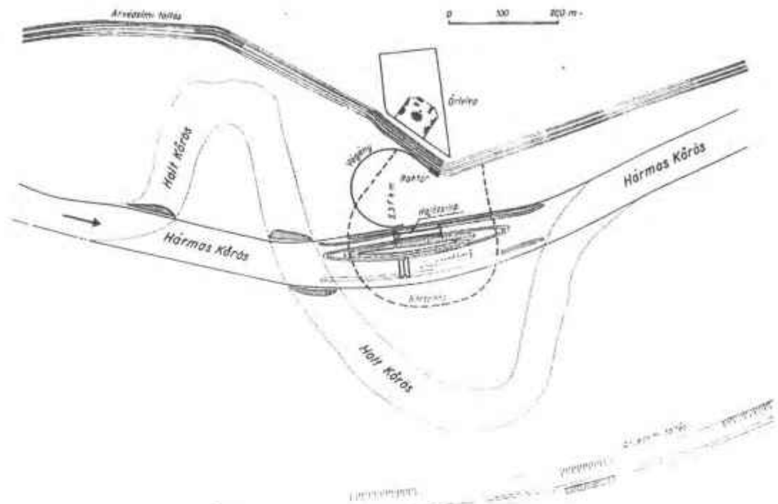
83. ábra. A hármas Kőrös vízlépcső általános elrendezése
