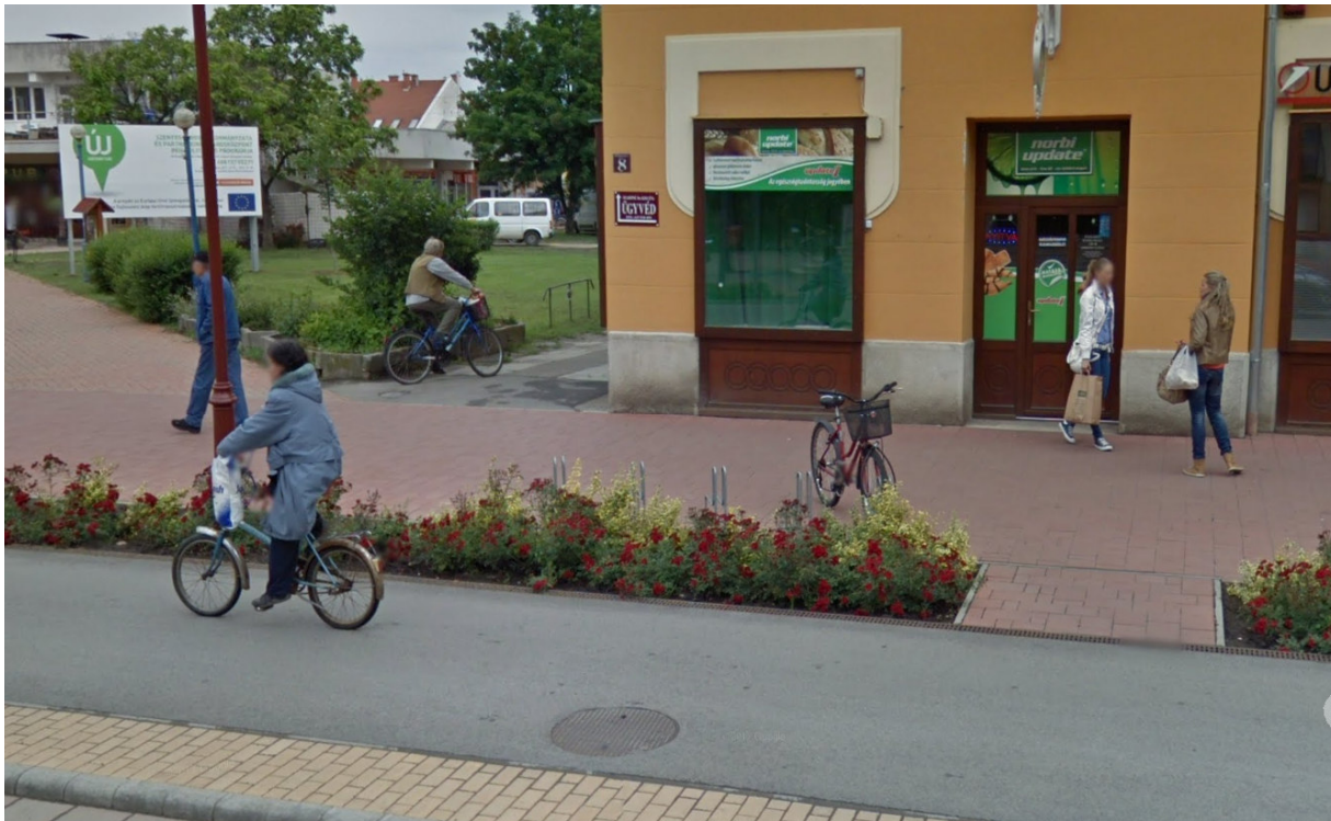
15. kép. 19 Kossuth Lajos utca, kizárólag a keréknél történő rögzítést lehetővé tevő nem megfelelő kerékpártámasz
